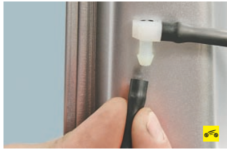
7. Отсоедините шланг от углового соединения на капоте.
