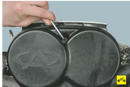
8. Выверните болты крепления верхней крышки...
