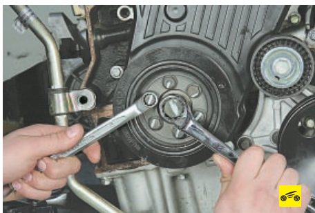
5. Удерживая шкив от проворачивания, вторым ключом выверните шесть болтов крепления шкива привода вспомогательных агрегатов к ступице коленчатого вала, снимите шкив.
