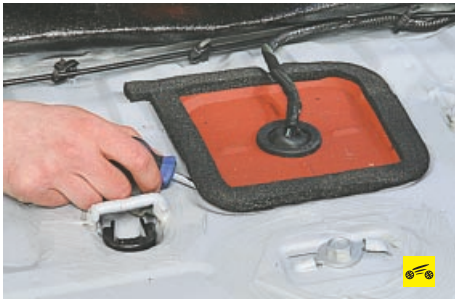
4. Подденьте отверткой крышку люка над топливным баком...
