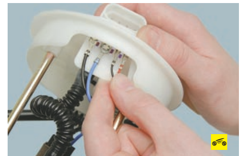
15. ...отсоедините колодки проводов от клемм...
