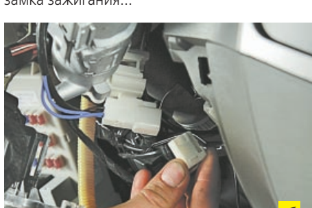
21. Сжимая фиксаторы, отсоедините колодки жгутов проводов от контактной группы замка зажигания...
