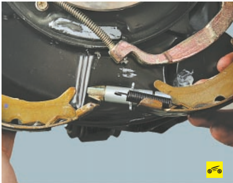
11. ...и снимите переднюю колодку, регулировочное устройство и нижнюю стяжную пружину.
