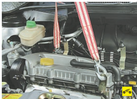
1. Установите под двигатель надежную опору или вывесите его грузоподъемным механизмом.
