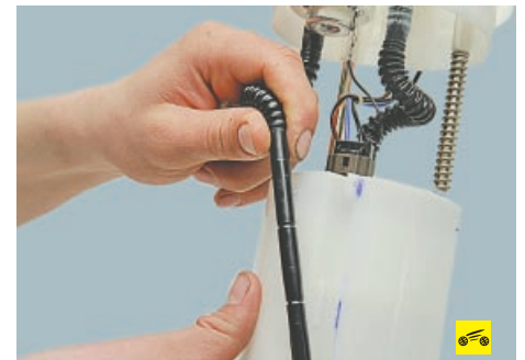
17. Выведите из держателей сливной шланг и отсоедините его от штуцера на стакане топливного модуля.
