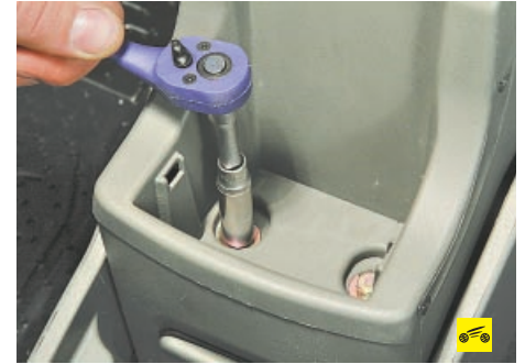
1. Снимите заднюю часть облицовки тоннеля пола (см. «Снятие и установка облицовки тоннеля пола», с. 245).
