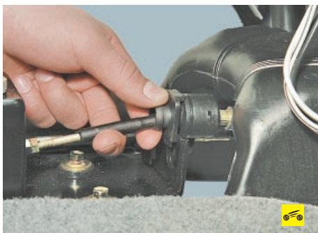
6. Извлеките наконечники оболочек тросов из прорезей кронштейна на тоннеле пола.
