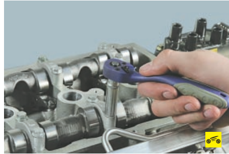
11. Выверните болты крепления четырех крышек подшипников впускного распределительного вала...
