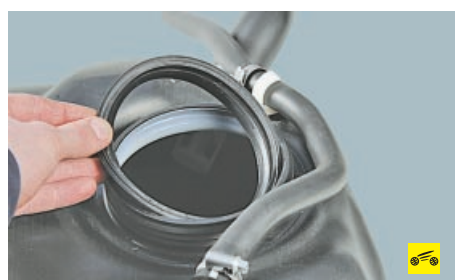
12. Запомнив положение модуля топливного насоса относительно топливного бака (чтобы облегчить его установку при обратном монтаже), аккуратно извлеките модуль и слейте из него топливо в заранее подготовленную емкость.
