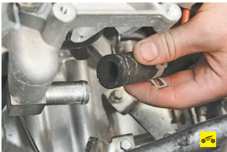
27. Аналогичным способом отсоедините шланги системы отопления салона от патрубка корпуса термостата...
