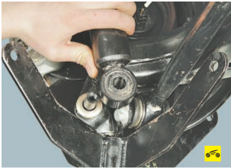
4. ...и отведите амортизатор от продольного рычага подвески.
