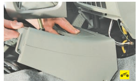
1. Снимите облицовку тоннеля пола (см. «Снятие и установка облицовки тоннеля пола», с. 245).
