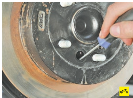
16. Плоской отверткой вращайте зубчатый венец регулировочного устройства, оперев стержень отвертки о край отверстия, до момента соприкосновения тормозных колодок с внутренней рабочей поверхностью тормозных барабанов внутри тормозных дисков (момент соприкосновения определяется по затрудненному вращению диска рукой). Поверните зубчатый венец регулировочного устройства в обратную сторону до момента освобождения тормозного диска.
