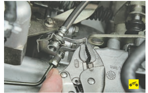
36. Снимите запорную скобу и извлеките наконечник шланга гидропривода выключения сцепления из кронштейна на картере коробки передач.
