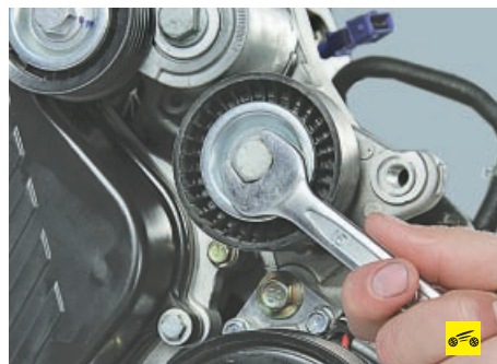
19. Выверните болт крепления промежуточного ролика ремня привода вспомогательных агрегатов...
