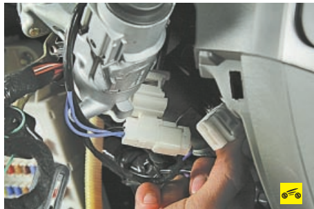
21. Сжимая фиксаторы, отсоедините колодки жгутов проводов от контактной группы замка зажигания...
