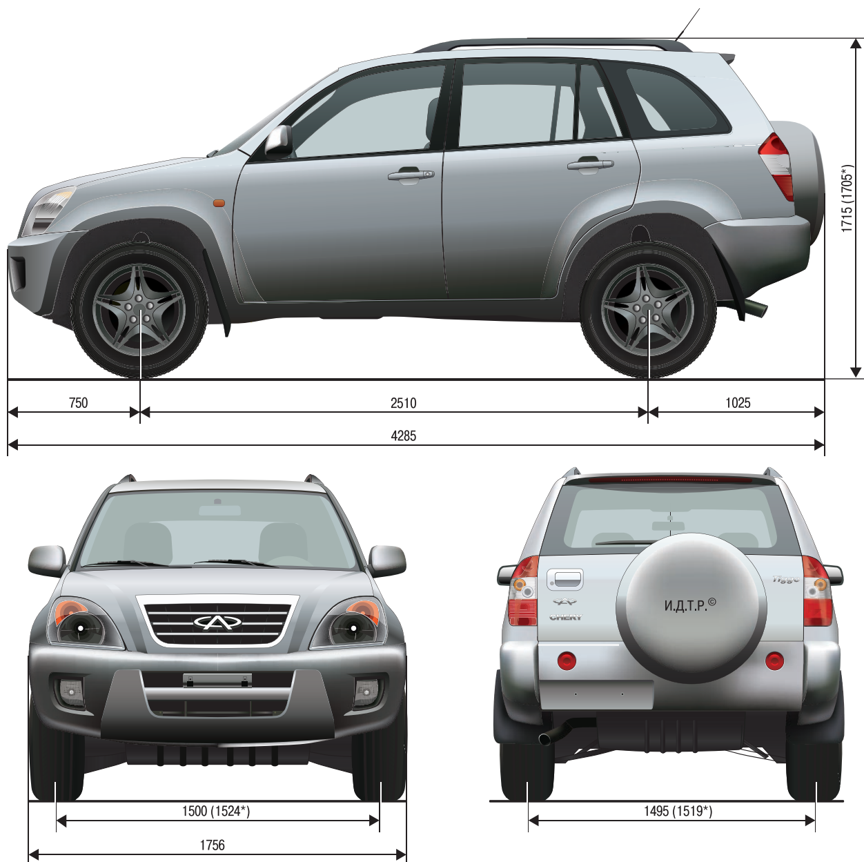
Рис. 1.1. Габаритные размеры автомобиля (*Автомобили с колесами 235/60 R16).
