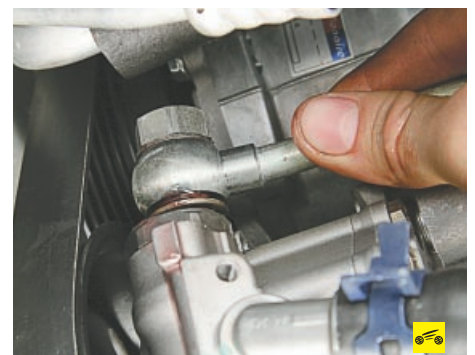
40. ...и отсоедините шланг напорной магистрали от насоса гидроусилителя.
