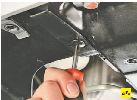
9. Для снятия правого брызговика выверните винт его крепления к продольной балке...
