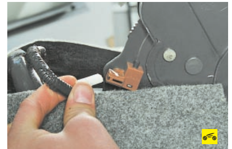
3. Отсоедините колодку жгута проводов от выключателя сигнальной лампы включения стояночного тормоза.
