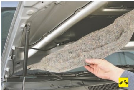
4. Снимите шумоизоляционную обивку капота.
