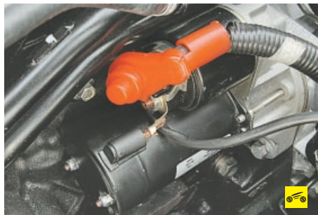
32. Откиньте защитный колпачок наконечника силового провода стартера...
