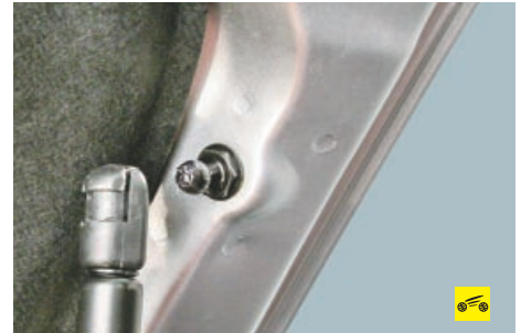
12. ...и отсоедините шарнир от опоры на капоте.
