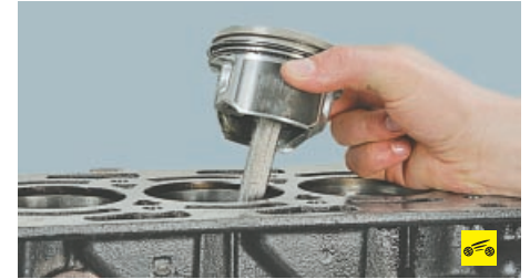
37. ...и выньте поршень с шатуном из цилиндра в сторону верхней плоскости блока цилиндров.
