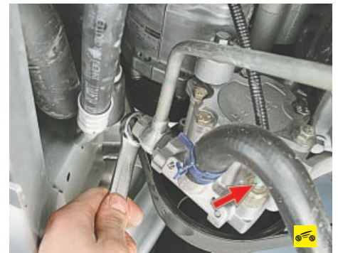
39. Отсоедините колодку провода (указана стрелкой) от датчика давления в системе гидроусилителя рулевого управления, выверните болт-штуцер муфты напорной магистрали...
