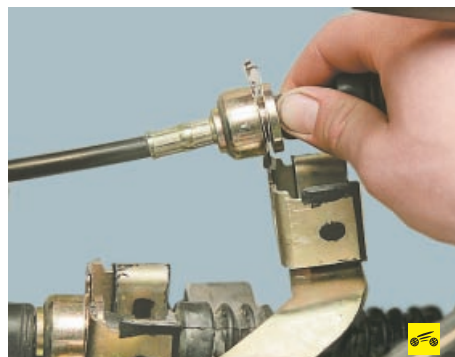
11. Преодолевая усилие пружинного фиксатора, извлеките наконечник оболочки троса выбора передач из прорези кронштейна, закрепленного на картере сцепления.
