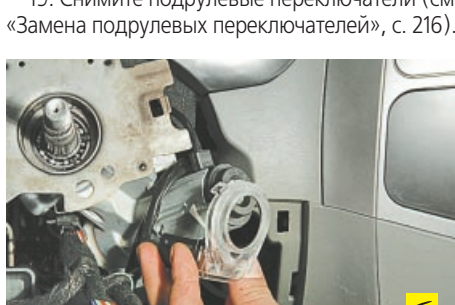
18. ...и снимите спиральный провод подушки безопасности.
