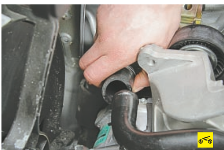
30. ...и отсоедините шланг от водораспределительной трубы.
