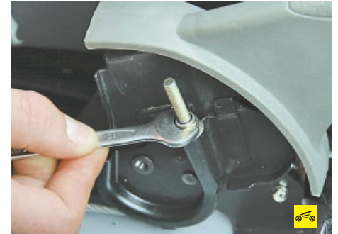
2. Полностью отверните регулировочную гайку от резьбового хвостовика тяги уравнителя.
