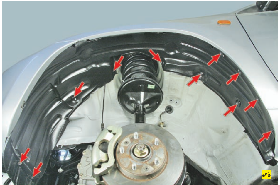
Рис. 11.1. Расположение фиксаторов крепления грязезащитного щитка арки переднего колеса
