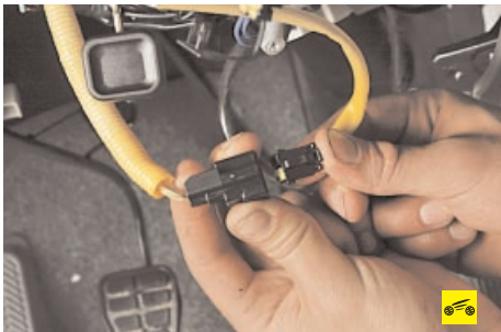
15. ...и разъедините колодку, сжав фиксаторы.
