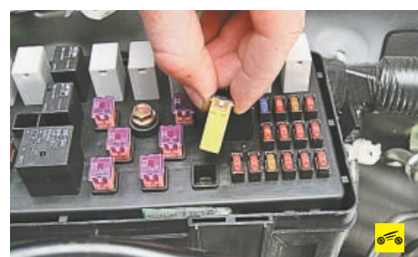
13. ...или плавкую вставку, покачивая их из стороны в сторону.
