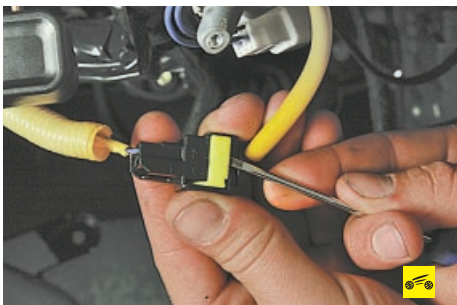
14. Откиньте предохранительную скобу колодки жгута проводов подушки безопасности...
