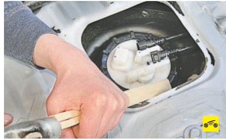
10. Ослабьте затяжку прижимного кольца крепления модуля топливного насоса к топливному баку, проворачивая кольцо против часовой стрелки аккуратными ударами молотка через деревянную выколотку...
