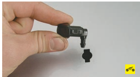
10. Отжав отверткой фиксаторы, снимите с капота оба жиклера омывателя ветрового стекла.
