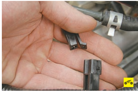
31. Отжав фиксатор, разъедините колодку управляющего провода тягового реле стартера.
