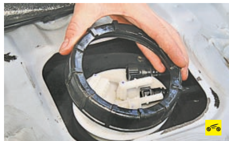
11. ...и отверните кольцо от горловины топливного бака.
