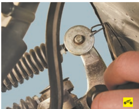
8. Извлеките шплинт крепления наконечника троса выбора передач из отверстия пальца рычага...
