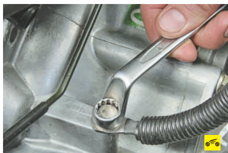
34. Выверните болт крепления наконечника «массового» провода силового агрегата.
