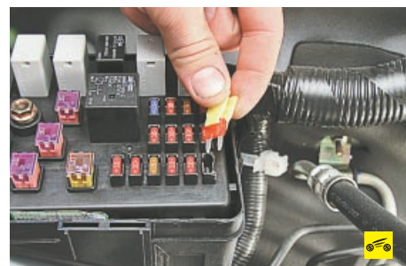
10. ...и с его помощью извлеките заменяемый предохранитель.
