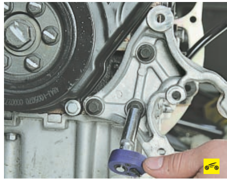
17. Выверните три болта крепления кронштейна генератора...
