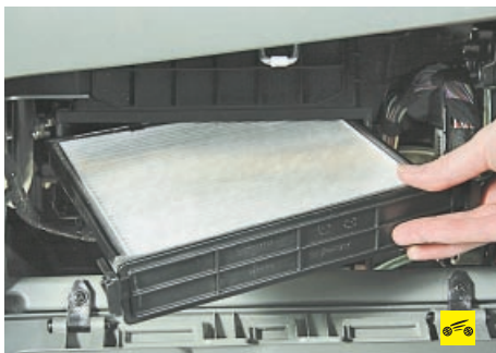
4. ...и извлеките салонный фильтр в сборе с корпусом.
