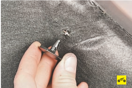
3. ...и извлеките из отверстий в усилителе капота пластиковые держатели шумоизоляционной обивки капота.
