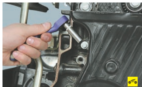
10. Выверните болты крепления нижней крышки...
