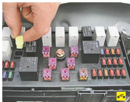
9. Достаньте из гнезда монтажного блока специальный пластмассовый пинцет...
