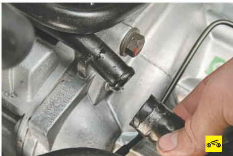
28. ...и от водораспределительной трубы.
