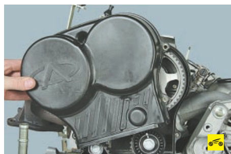
9. ...и снимите верхнюю крышку газораспределительного механизма.
