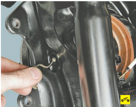
12. Выньте из отверстий в тормозном щите опорные стойки колодок.
