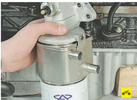
14. ...снимите теплообменник в сборе с масляным фильтром...
