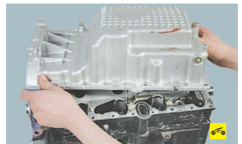
25. Снимите масляный картер (см. «Замена уплотнения масляного картера», с. 88)...
