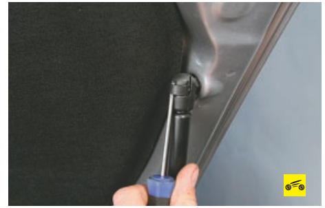
11. Поддев отверткой, снимите пружинный фиксатор верхнего шарнира газонаполненного упора...
