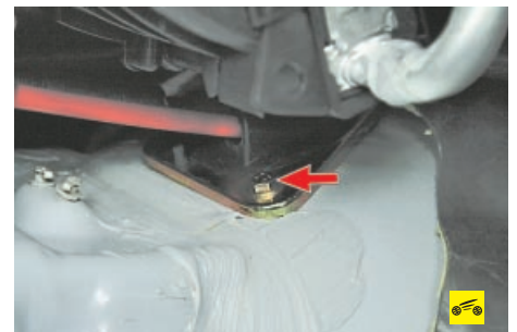
13. Под панелью приборов выверните два болта крепления уплотнителя тросов и извлеките тросы в салон, поочередно вынимая их наконечники через отверстие в тоннеле пола.
