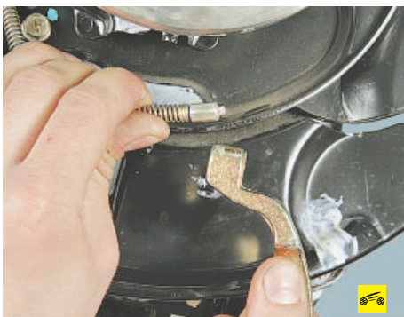
13. Отсоедините от наконечника троса стояночного тормоза и снимите заднюю колодку.
