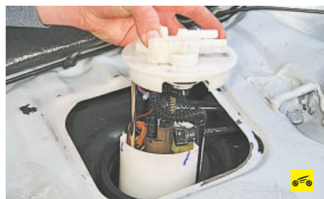
12. Запомнив положение модуля топливного насоса относительно топливного бака (чтобы облегчить его установку при обратном монтаже), аккуратно извлеките модуль и слейте из него топливо в заранее подготовленную емкость.
