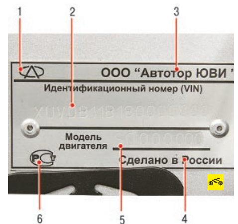
Рис. 1.6. Идентификационная табличка: 1 – фирма – разработчик автомобиля; 2 – идентификационный номер автомобиля; 3 – завод-изготовитель; 4 – страна местонахождения завода-изготовителя; 5 – тип двигателя; 6 – знак соответствия сертификации
