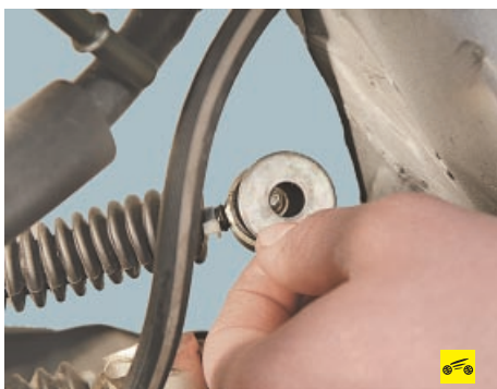
9. ...после чего снимите с пальца плоскую шайбу...
