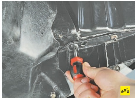
12. Выверните винт крепления переднего брызговика правого колеса, после чего снимите правый брызговик двигателя.
