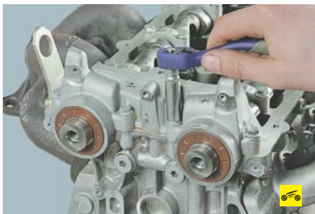
8. Выверните четыре болта крепления крышки передних подшипников распределительных валов...
