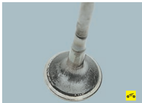
Рис. 5.4. Зоны износа клапана: 1 – зона наименьшего износа стержня; 2 – торец стержня; 3 – проточка под сухари; 4 – зоны наибольшего износа стержня; 5 – рабочая фаска; 6 – кромка тарелки
