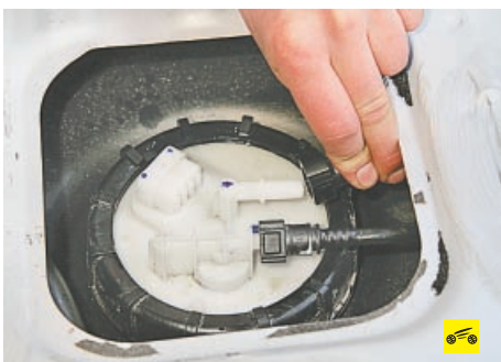
8. Сжав пластмассовые фиксаторы, отсоедините от штуцеров модуля наконечники сливного топливопровода.
