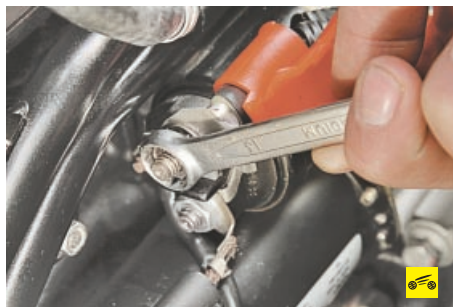
33. ...отверните гайку крепления и снимите провод с контактного болта тягового реле.
