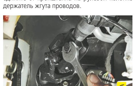
24. Выверните болт клеммового соединения вала рулевой колонки с карданным шарниром промежуточного рулевого вала.
