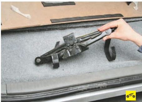
4. ...извлеките чехол с ключом для гаек колес и воротком домкрата...
