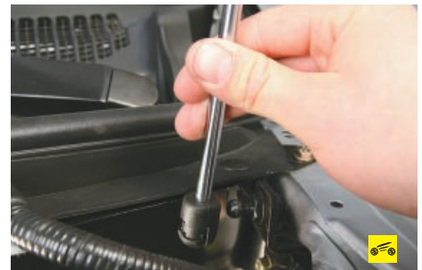
13. Аналогично отсоедините нижний шарнир газонаполненного упора от опоры на кузове и снимите упор. Таким же образом снимите и второй упор.
