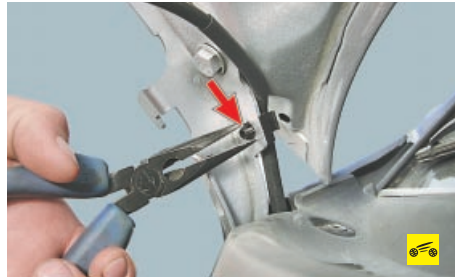
8. Сжав пассатижами пружинные фиксаторы, извлеките держатель шланга из отверстия в правой петле капота...
