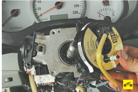
18. ...и снимите спиральный провод подушки безопасности.
