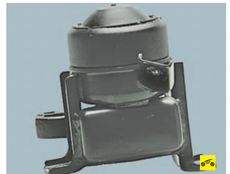
5. Осмотрите опору. При наличии вспучивания, растрескивания массива резины, отслоения его от стальной обоймы, а также при наличии трещин в обойме и кронштейнах замените опору.
