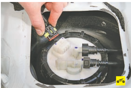
7. ...и отсоедините колодку жгута проводов от топливного модуля.
