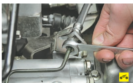
35. Отверните гайку крепления трубки гидропривода выключения сцепления и отсоедините трубку от шланга.
